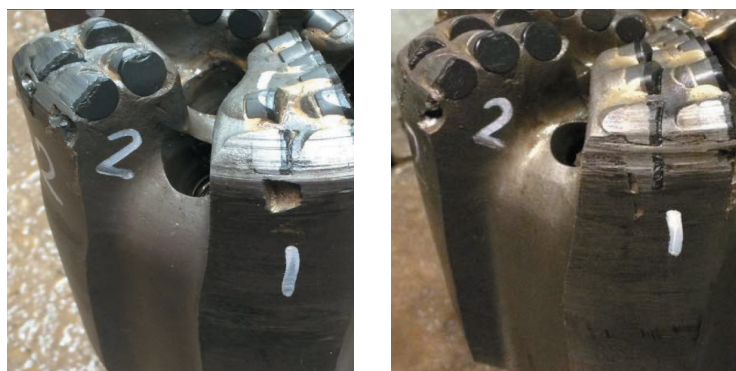
Рис. 7. Критический кольцевой износ долот после бурения по абразивному песчанику
