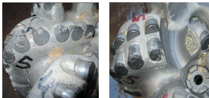
Рис. 2. Сильный износ долот при бурении секции
