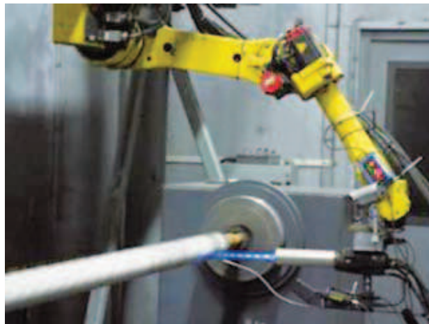
Рис. 4. Роботизированная установка для нанесения твердосплавного покрытия методом HVOF
