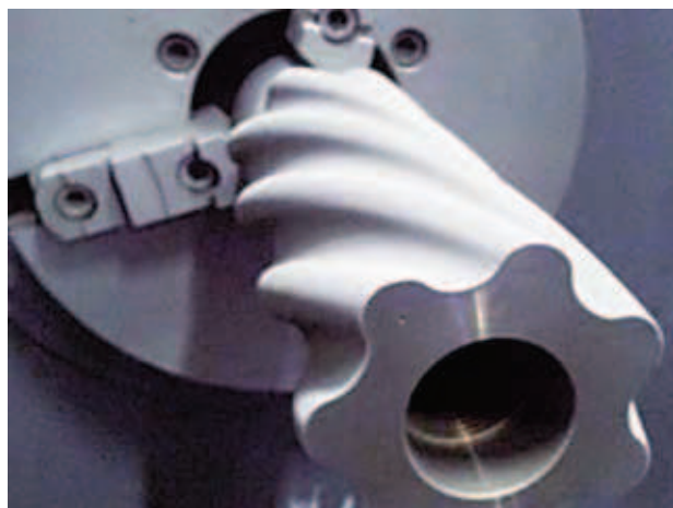
Рис. 5. Ротор с покрытием карбида вольфрама
