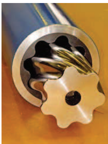
Рис. 3. Макет двигательной секции 172 мм, заходность 7/8
